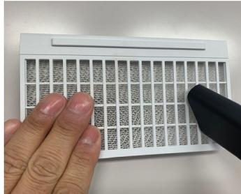
5. フィルターカバーをもって、細目のエアフィルターを取り外してください。粗目のエアフィルターはフィルターカバーに残すようにします。
